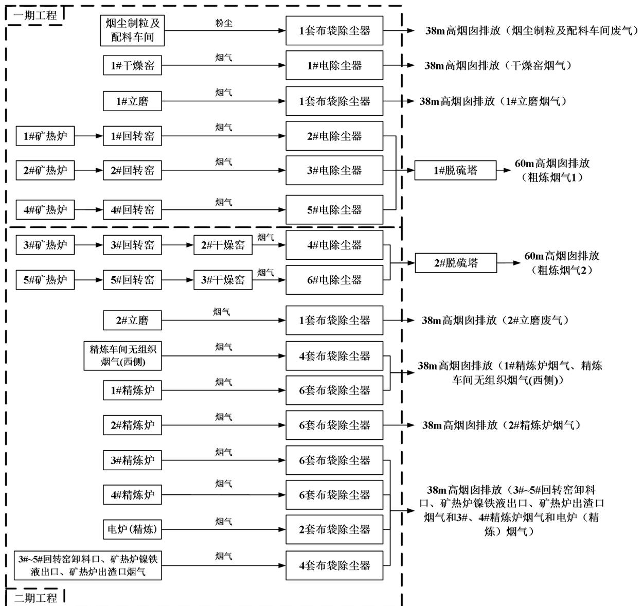
图 2.7-1 一期、二期工程废气处理工艺流程
